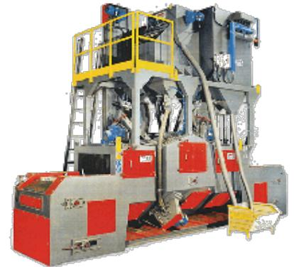
Die Geschwindigkeit des Fördergurtes lässt sich stufenlos einstellen und die Schleuderräder sind so angeordnet, dass das Strahlmittel aus verschiedenen Richtungen auf das Strahlgut prallt. Damit ist eine allseitige und gleichmäßige Beaufschlagung und Bearbeitung der Werkstücke gewährleistet.
